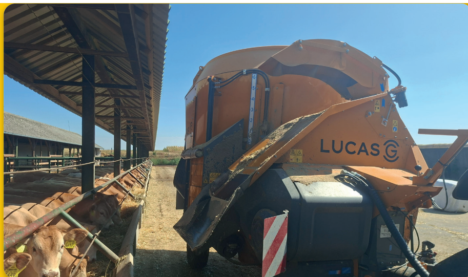
Lucas Spirmix Jet 140 univerzális kifúvótoronnyal, programozható mérleggel, hidraulikus ellenkésállítással és a tartály tetején túlsordulást gátló gyűrűvel rendelkezik
