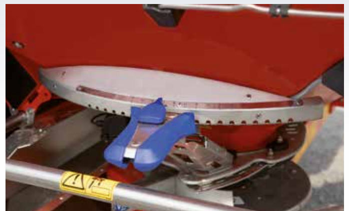
A kirepítési pont manuális állítása
