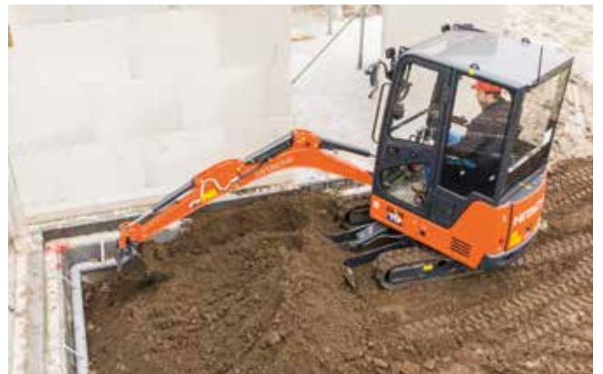
Az alacsony minimális előlő fordulási sugár ideális a szűk helyeken való használathoz.
