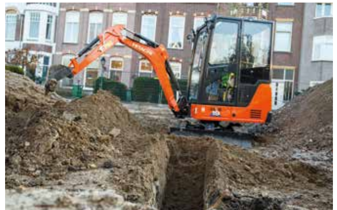
A gémmozgató munkahenger a gém tetején található, ami csökkenti a hengerrel való érintkezést, ezáltal minimalizálja az állásidőt.
