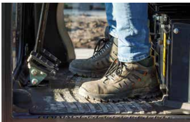
Felhajtható menetpedálok használhatók a kézika helyett.
