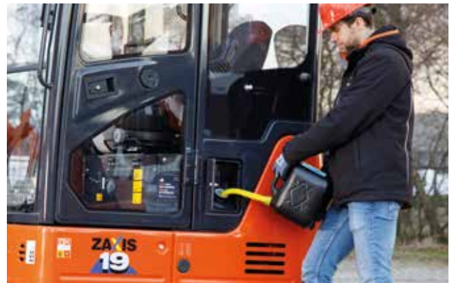
Az áthelyezett üzemanyagtartály-nyílás megkönnyíti a tankolást.
