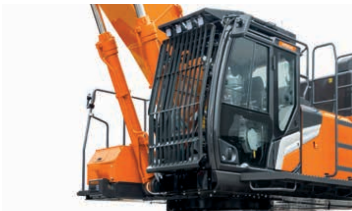
Az elülső burkolat, a tetőburkolat és a négy fülkelámpa az alapfelszereltség részei a ZX530LCH-7 esetében.
