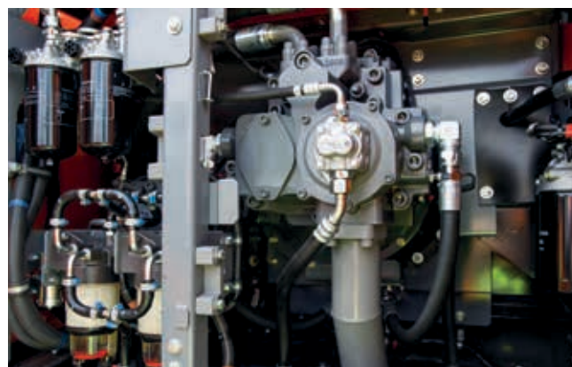
A HIOS V hidraulikus rendszerrel akár 11%-os üzemanyag-megtakarítás érhető el.
