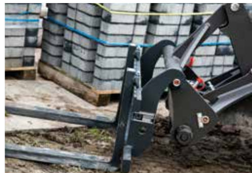
A munkaeszközök biztonságosan és egyszerűen csatlakoztathatók a gyorscsatlakozóval.
